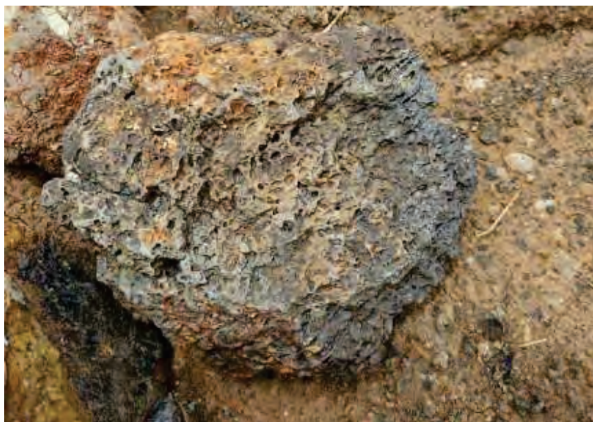
รูปที่ 18 ภาพถ่ายหินบะซอลต์ลักษณะเป็นเนื้อพุรูน (พิกัดถ่ายภาพ 202089 E , 1619523 N)
